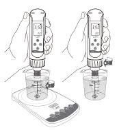
取适量样品,置入量测杯内。 将测试笔置入杯内,深度不超过5cm 请搅动测量,待最大读值出现,就完成测量。
